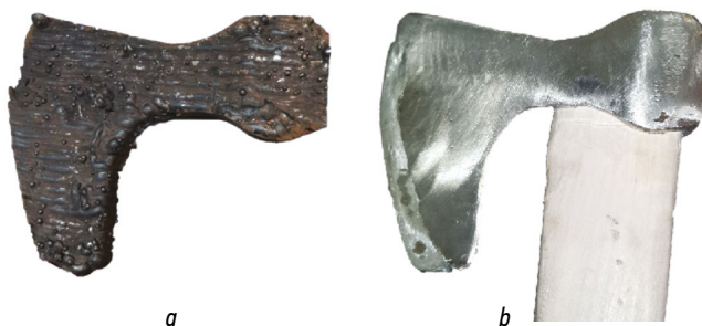
Рис. 5. Реплика средневекового топорика, выращенная по технологии электродугового выращивания с помощью СПРУТКАМ: a — заготовка до механической обработки; b — заготовка после механической обработки.
