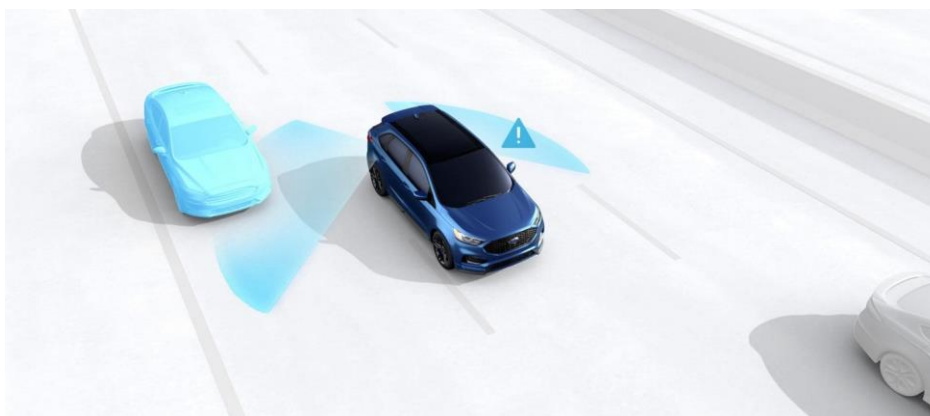
Рис. 2. Система BLIS (Ford) [4]
