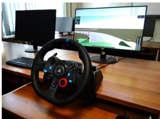
Рис. 4. Общий вид комплекса натурно-математического моделирования (экран и органы управления)
