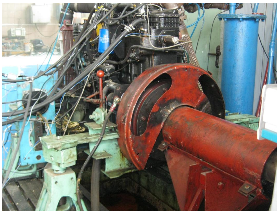
Рис. 3. Общий вид дизеля 4ЧН 11,0/12,5 (Д-245.5S5) с модернизированной системой питания
