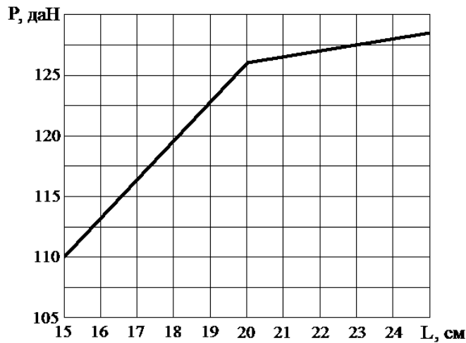
Рис. 3. Зависимость предельной внешней касательной силы на траке от шага грунтозацепов при весе трака с грузами 47даН
