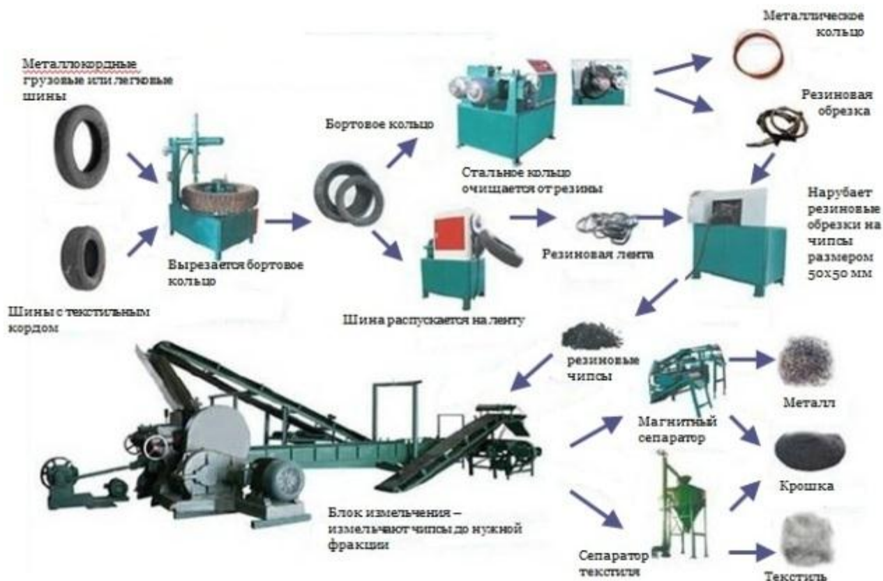
Рис. 5. Полуавтоматическая линия по переработке шин в крошку [http://www.import-terminal.ru/raznoe/128-oborudovanie-dlya-pererabotki-shin.html]
