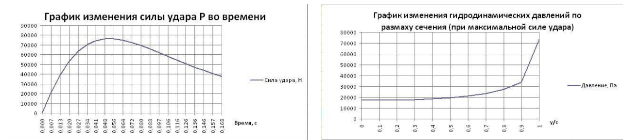
Рис. 2. Результаты расчетов ударных нагрузок, действующих на СПК
