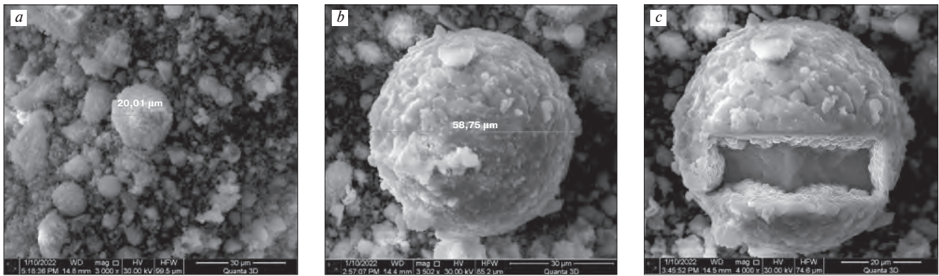
Рис. 3. Микрочастица аспирационной пыли (a); размер зерен (b); частица после ионного травления (c) Fig. 3. Microparticle of aspiration dust (a); grain size (b); particle after ion etching (c)
