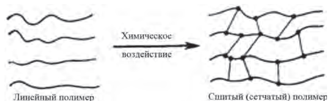
Рис. 1. Схема формирования сетчатого полимера
