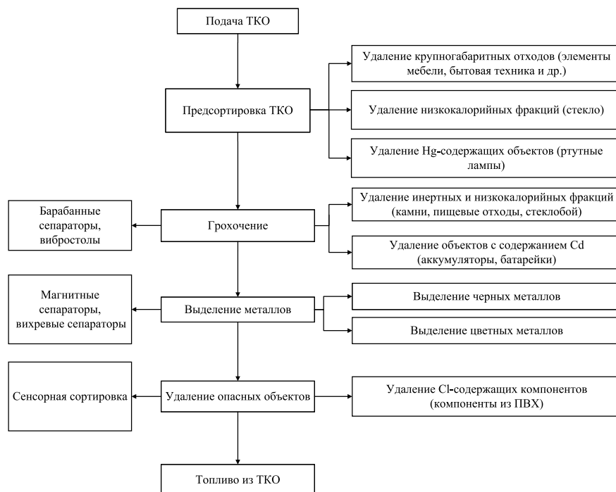
Рис. 2. Принципиальная схема целевого подхода при получении топлива из ТКО.
